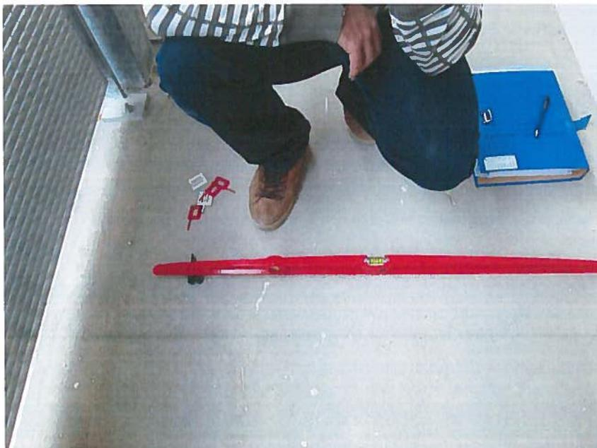
**Schéma 3 - Contrôle de la pente in situ**
